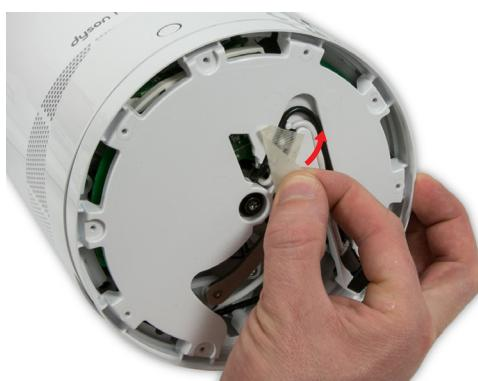
**03** Entfernen Sie das Glasfasergewebeband.
