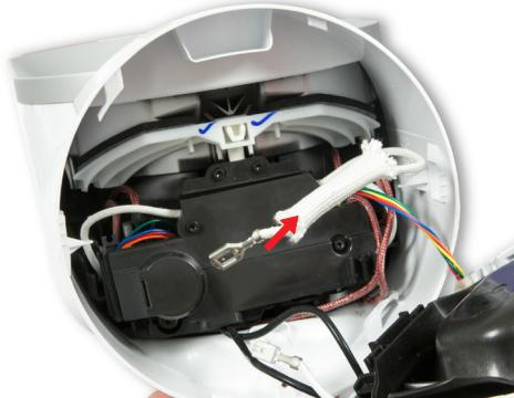
**83** Schieben Sie den Glasfasergewebeschlauch über die Amp-Seite des neutralen Kabels.
