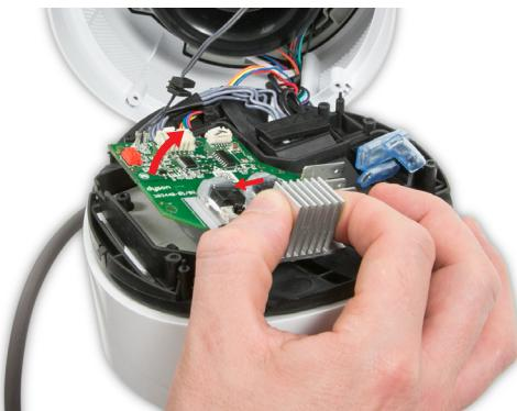
**50** Entfernen Sie die Triac-Platine wie abgebildet von der Kipplatte.
