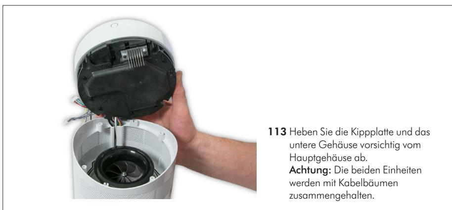
**113** Heben Sie die Kippplatte und das untere Gehäuse vorsichtig vom Hauptgehäuse ab.
