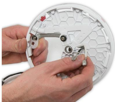
**33** Führen Sie die Netzkabel durch die Grundplatteneinheit.
