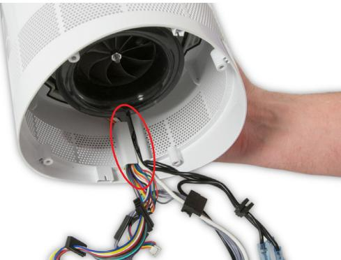
**131** Setzen Sie die Kabelbäume in den Kanal an der Seite des Hauptkörpers ein.
