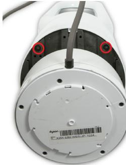
**43** Entfernen Sie die vier 12-mm-T-10-Schrauben an der Vorder- und Rückseite der Kippplatte.
