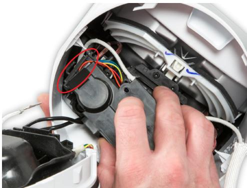
**75** Setzen Sie die Leiste an der Abdeckung vorsichtig in den Spalt in der Anschlussplatte.
