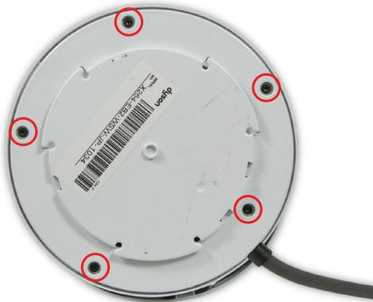
**02** Entfernen Sie die fünf 6-mm-T-8-Schrauben.
