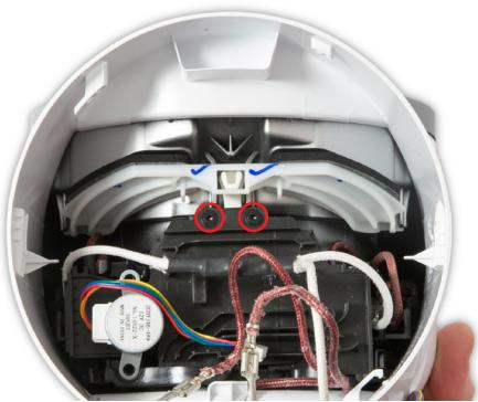
**107** Montieren Sie die beiden 10-mm-T-8-Schrauben mit verbundenen Unterlegscheiben in der Kabelplatte.
