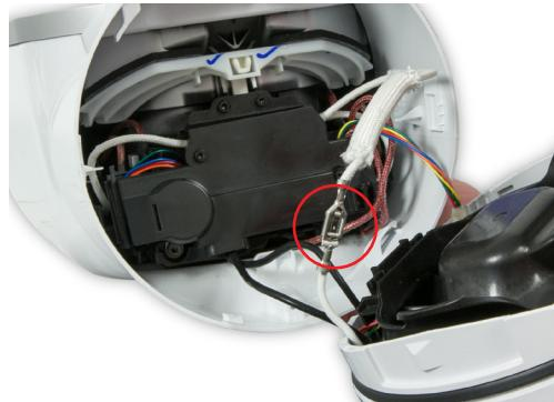
**84** Schließen Sie die beiden neutralen Kabel an.
