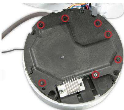
**56** Setzen Sie die Platinenabdeckung auf die Platine und bringen Sie die sieben 12-mm-T-8-Schrauben an.
