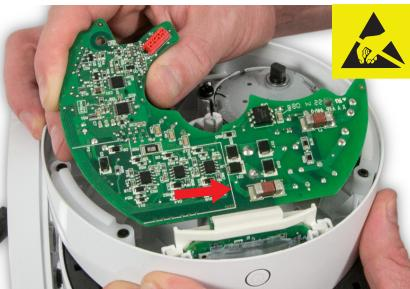
**18 Wichtig:** Setzen Sie das flache Ende der Platinen- und Flachkableinheit in die Halterung ein. Schieben Sie die Platine entlang, bis sie zentriert ist. Senken Sie die Platine auf die Schraubansätze ab.
