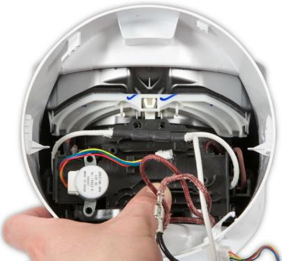
**106** Vergewissern Sie sich, dass alle Kabel frei sind, und positionieren Sie die Kabelplatte über den Schraubansätzen.
