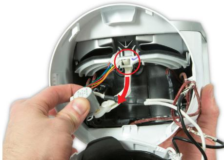
**95** Lösen Sie den Motorhebelarm von der Durchflussfokusklappeneinheit.
