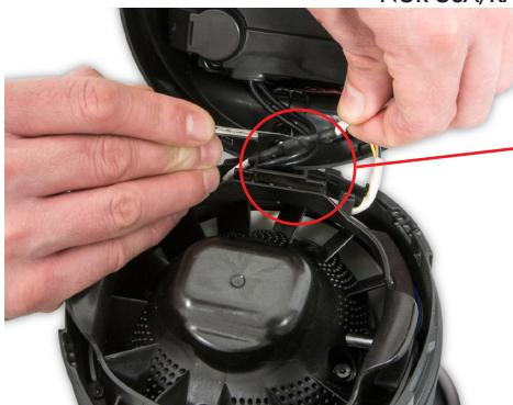
**64** Schneiden Sie den Schrumpfschlauch am Neutralleiteranschluss sehr vorsichtig auf, wobei die Klinge auf dem Metallteil des Anschlusses bleiben muss.
