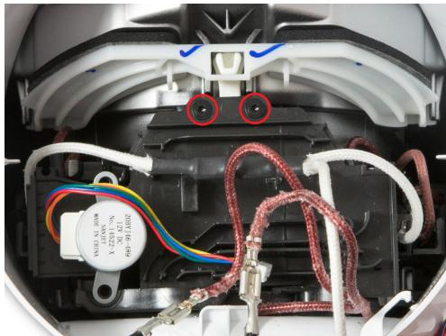
**93** Entfernen Sie die beiden T-10-Schrauben, mit denen die Kabelplatte an der Amp befestigt ist.
