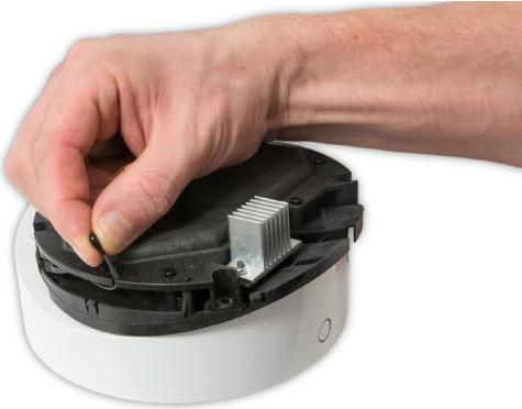
**57** Befestigen Sie den Thermosensor in der Leiterplattenabdeckung.
