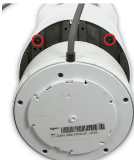
**59** Montieren Sie die vier 12-mm-T-10 Schrauben.
