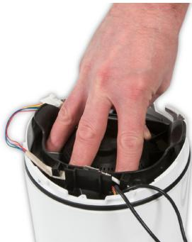
**128** Drücken Sie die Motor- und Halterungseinheit fest in das Hauptgehäuse, um sicherzustellen, dass die Dichtung fest sitzt.
