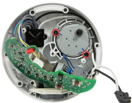
**13** Montieren Sie den neuen Oszillationsmotor und die beiden 12-mm-T-15 Schrauben.
