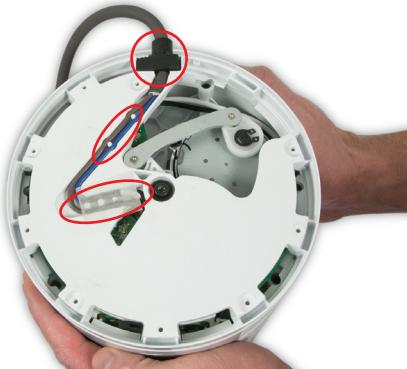
**25** Legen Sie das stromführende und neutrale Kabel in die dafür vorgesehenen Halterungen in der Grundplatte.
