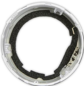
**122** Prüfen Sie die Schaumstoffdichtung der Motorhalterung auf Schäden. Wenn die Schaumstoffdichtung der Motorhalterung nicht ersetzt werden muss, fahren Sie mit Schritt 130 fort.
