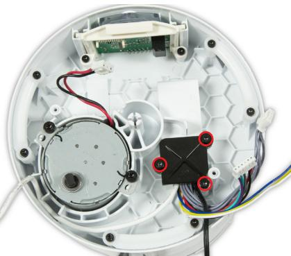
**110** Entfernen Sie die drei T-8-Schrauben, die die Tüllenabdeckung halten.
