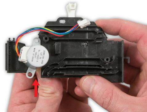
**104** Schieben Sie den Durchflussmodusmotor wie abgebildet in die Kabelplatte.
