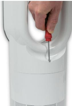
**61** Entfernen Sie die 10-mm-T-8-Schraube.
