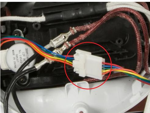
**72** Schließen Sie den Kabelbaum des Durchflussmodusmotors an.
