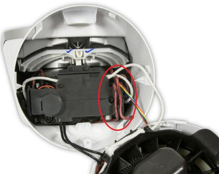
**63** Lösen Sie die Kabel aus der Halterung in der Abdeckung.
