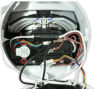
**108** Montieren Sie die beiden 10-mm-T-10-Schrauben in den Durchflussmodusmotor.
