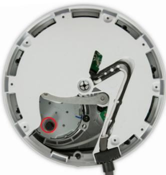
**05** Hebeln Sie die Oszillationsnocke vom Oszillationsmotor ab.
