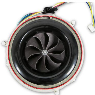
**124** Legen Sie die Dichtung in die Rille der Motorhalterung.
