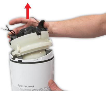
**121** Heben Sie die Motor- und Halterungseinheit vom Gehäuse des Hauptkörpers ab.
