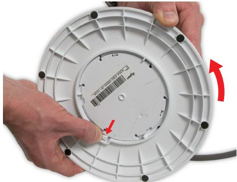
**01** Drücken Sie die Verriegelung und drehen Sie die Basiseinheit ab.
