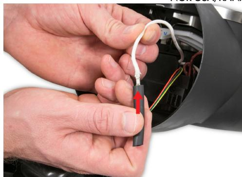
**78** Schieben Sie den Schrumpfschlauch über die Amp-Seite des neutralen Kabels.
