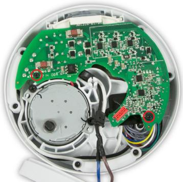
**19** Montieren Sie die beiden 10-mm-T-8-Schrauben.
