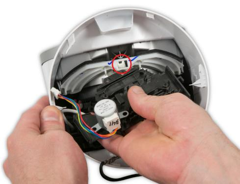
**105** Führen Sie das Ende des Motorhebelarms in das Loch in der Durchflussfokusklappeneinheit ein.
