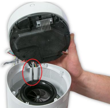
**58** Setzen Sie das untere Gehäuseteil ein.
