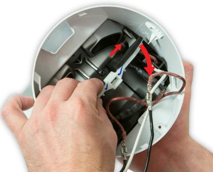
**98** Lösen Sie eine Seite der Durchflussfokusklappeneinheit.
