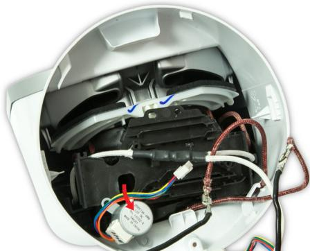
**94** Lösen Sie den Durchflussmodusmotor von der Kabelplatte.
