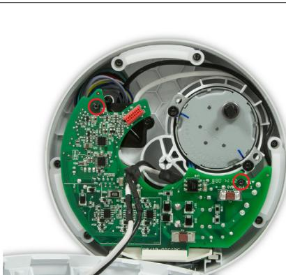
**09** Entfernen Sie die beiden 6-mm-T-8-Schrauben. Lösen Sie die Platinen- und Flachkableinheit vorsichtig aus der Halterung.
