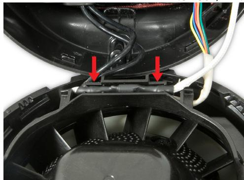
**82** Setzen Sie die Neutralleiteranschlüsse in die dafür vorgesehenen Halterungen im Hauptgehäuse ein.
