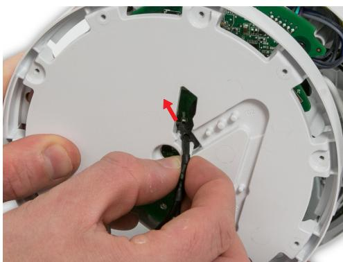
**08** Lösen Sie die Tülle aus der Mitte der Grundplatte.
