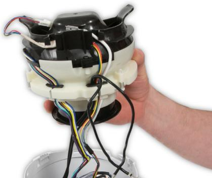
**126** Führen Sie die Kabelbäume durch das Hauptgehäuse.
