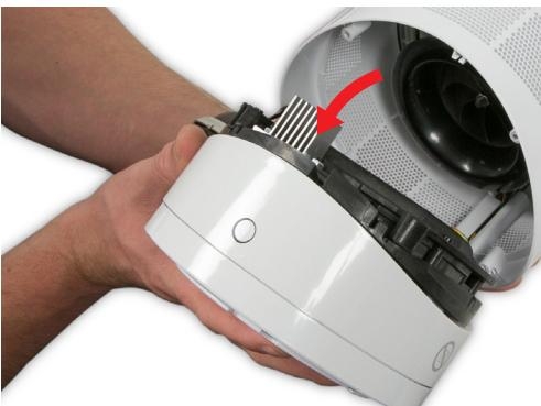
**44** Heben Sie die Kippplatte und das untere Gehäuse vorsichtig vom Hauptgehäuse ab.
