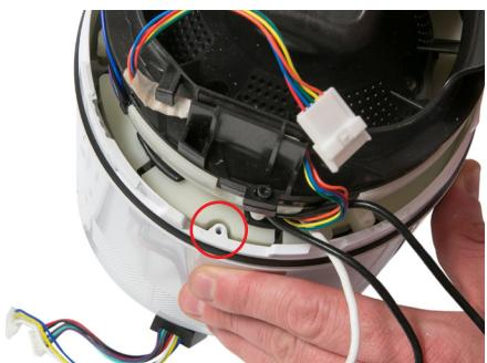
**130** Führen Sie die Kabelbäume durch das Hauptgehäuse.
