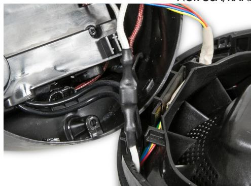
**81** Verwenden Sie vorsichtig eine Heißluftpistole, um sicherzustellen, dass der Schrumpfschlauch die Anschlüsse vollständig umschließt.
