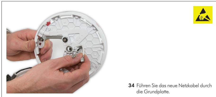
**34** Führen Sie das neue Netzkabel durch die Grundplatte.
