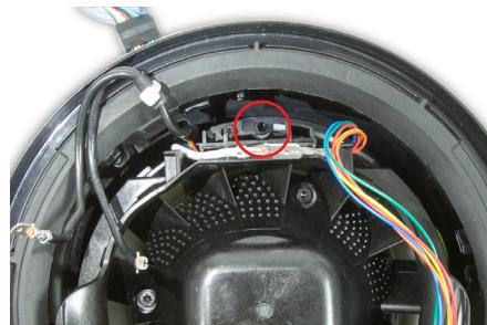
**143** Führen Sie die Kabelbäume durch das Hauptgehäuse.
