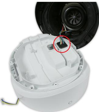
**146** Setzen Sie die größere Motorkabelbaumfülle sicher in die Kippplatte ein.
