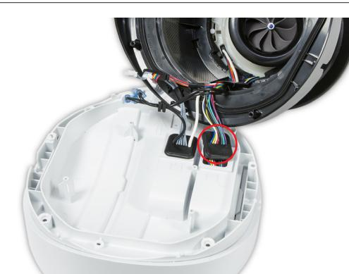
**131** Ziehen Sie die Tülle des Motorkabelbaums von der Kippplatte ab.
