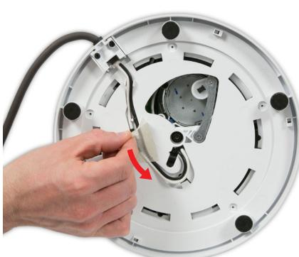
**03** Entfernen Sie das Glasfasergewebeband.
