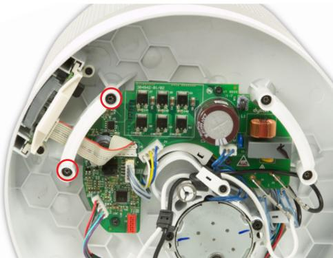
**38** Montieren Sie die Oszillationsschiene.
