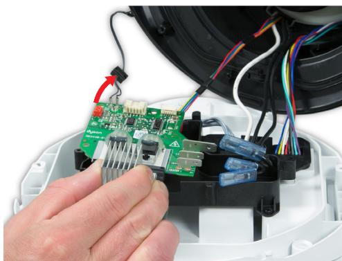
**56** Nehmen Sie die Triac-Platine wie abgebildet aus dem Gehäuse.
