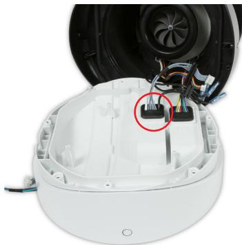
**149** Setzen Sie die größere Haupt-Amp-Kabelbaumtülle sicher in die Kippplatte ein.
