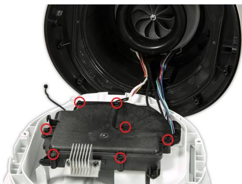
**52** Entfernen Sie die sieben 10-mm-T-8 Schrauben von der Abdeckung der Triac-Platine.
