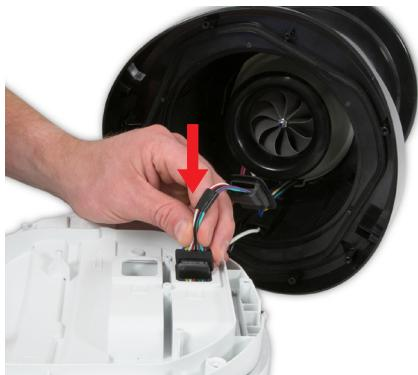
**144** Führen Sie den Motorkabelbaum durch die Kippplatte und in das untere Gehäuse.
