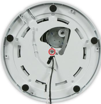
**06** Entfernen Sie die 30-mm-T15-Schraube und die fest verbundene Unterlegscheibe.
