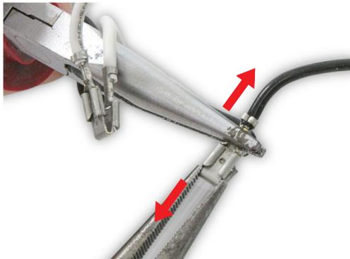
**120** Trennen Sie die stromführenden und neutralen Kabel mit einer Spitzzange vorsichtig von den Doppelsteckhülsen.
