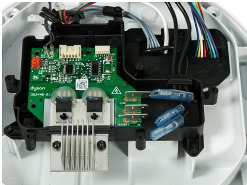
**57** Setzen Sie die neue Triac-Platineneinheit in die Kippplatte ein.
