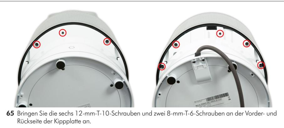
**65** Bringen Sie die sechs 12-mm-T-10-Schrauben und zwei 8-mm-T-6-Schrauben an der Vorder- und Rückseite der Kipplatte an.
