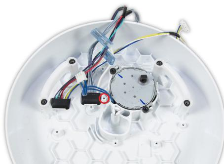
**122** Vergewissern Sie sich, dass keine Kabel eingeklemmt sind.
