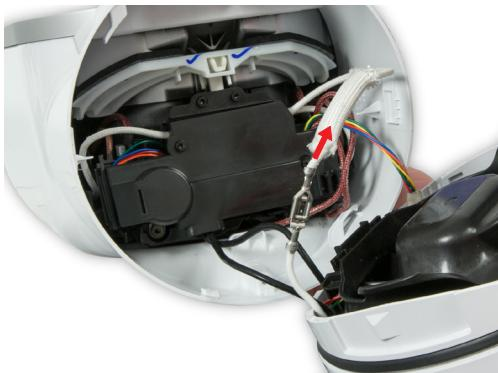
**70** Entfernen Sie die neutralen Kabel aus der Halterung in der Motorhalterungseinheit. Schieben Sie das Glasfasergewebeband von den Nullleiterklemmen weg.
