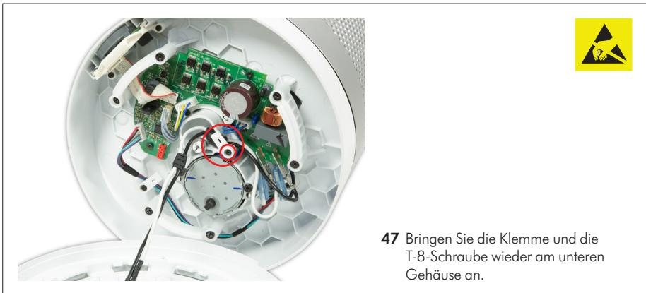
**47** Bringen Sie die Klemme und die T-8-Schraube wieder am unteren Gehäuse an.
