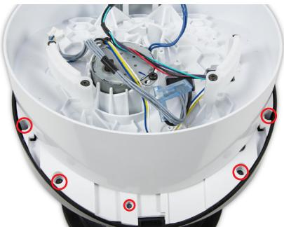
**123** Entfernen Sie die sechs 12-mm-T-10- und zwei 8-mm-T-6-Schrauben an der Vorder- und Rückseite der Kippplatte.
