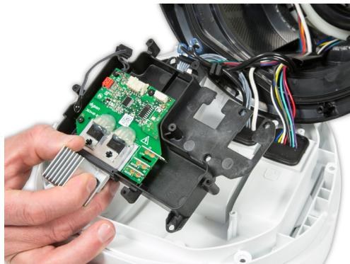
**130** Lösen Sie das Platinengehäuse.
