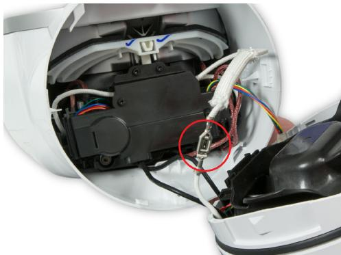
**82** Schließen Sie die beiden neutralen Kabel an.
