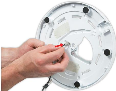
**44** Führen Sie die neue Netzkabeleinheit durch die Grundplatte.
