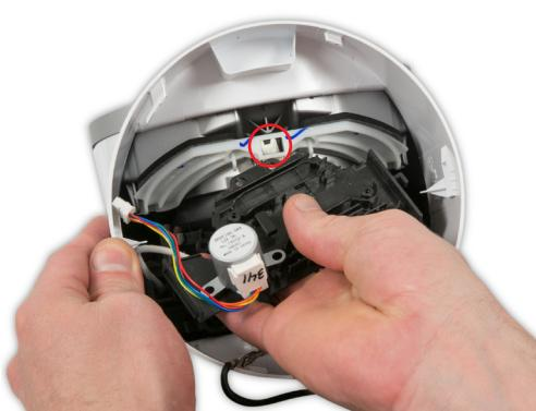
**107** Führen Sie das Ende des Motorhebelarms in das Loch in der Durchflussfokusklappeneinheit ein.
