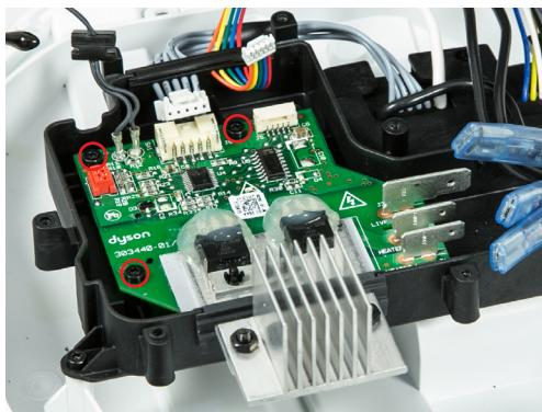
**55** Entfernen Sie die drei 10-mm-T-8-Schrauben.
