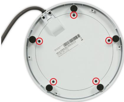
**01** Entfernen Sie die fünf 6-mm-T-8-Schrauben.
