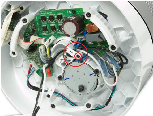
**43** Bringen Sie die Klemme und die T-8-Schraube wieder am unteren Gehäuse an.
