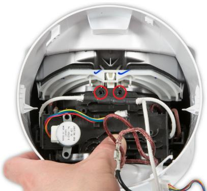
**108** Vergewissern Sie sich, dass alle Kabel frei sind, und positionieren Sie die Kabelplatte über den Schraubansätzen.
