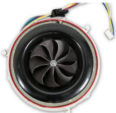
**137** Legen Sie die neue Dichtung in die Nut des Motorgehäuses.
