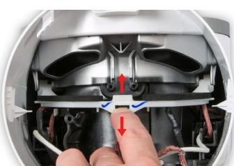
**103** Bringen Sie auch auf der anderen Seite an und testen Sie die Bewegung der Durchflussfokusklappeneinheit.
