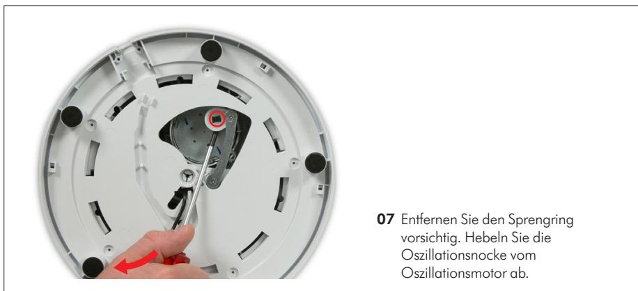
**07** Entfernen Sie den Sprengring vorsichtig. Heben Sie die Oszillationsnocke vom Oszillationsmotor ab.
