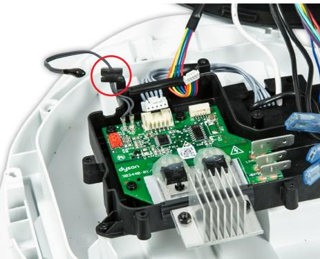
**54** Lösen Sie die Tülle des Thermosensors vorsichtig von der Kipplatte.
