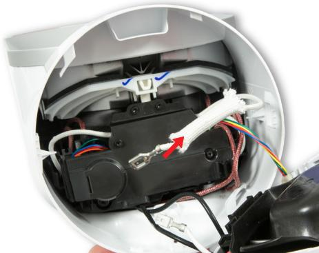
**81 Wichtig:** Schieben Sie den Glasfasergewebeschlauch über die Amp-Seite des neutralen Kabels.
