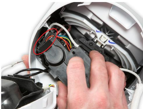
**79** Setzen Sie die Leiste an der Abdeckung vorsichtig in den Spalt in der Anschlussplatte.
