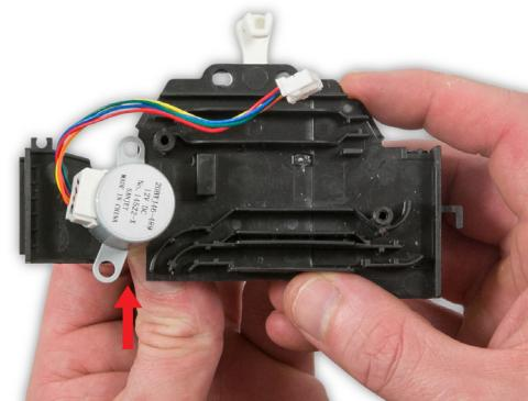
**106** Schieben Sie den Durchflussmodusmotor wie abgebildet in die Kabelplatte.
