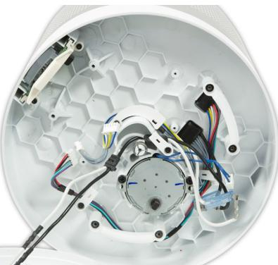
**35** Stellen Sie sicher, dass alle Kabel frei liegen und nicht von der neuen Hauptplatineneinheit eingeklemmt werden.
