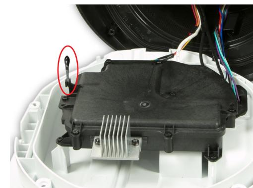
**63** Befestigen Sie den Thermosensor in der Leiterplattenabdeckung.
