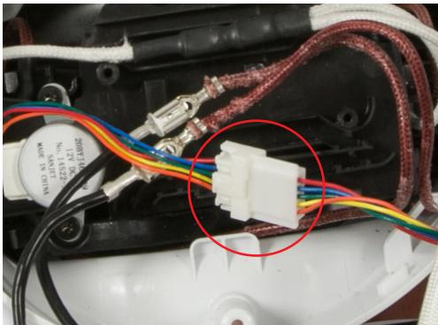
**76** Schließen Sie den Kabelbaum des Durchflussmodusmotors an.
