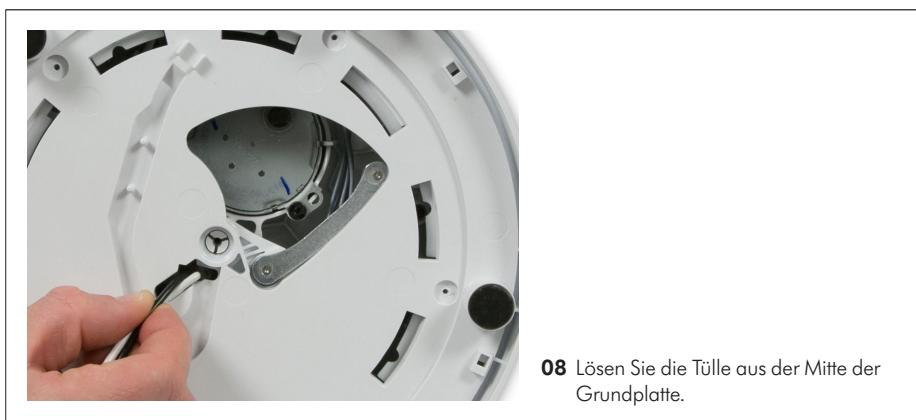
**08** Lösen Sie die Tülle aus der Mitte der Grundplatte.
