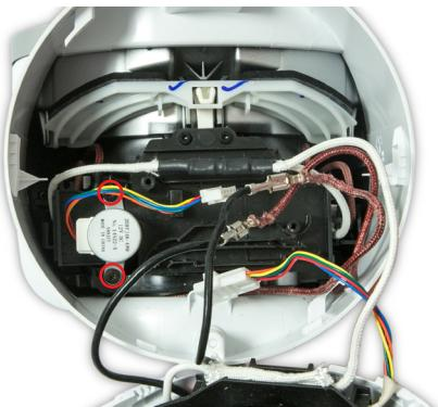
**110** Montieren Sie die beiden 10-mm-T-10-Schrauben in den Durchflussmotor.
