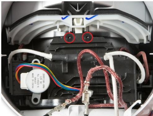
**95** Entfernen Sie die beiden T-8 Schrauben mit den verbundenen Unterlegscheiben, mit denen die Kabelplatte an der Amp befestigt ist.
