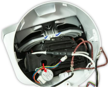
**96** Lösen Sie den Durchflussmodusmotor von der Kabelplatte.
