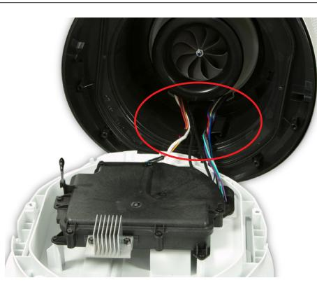
**50** Lösen Sie die Kabelbäume vorsichtig aus dem Kanal im Hauptgehäuse.
