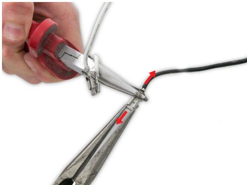
**22** Trennen Sie die stromführenden und die neutralen Kabel mit zwei Spitzzangen sehr vorsichtig von den Doppelsteckhülsen.
