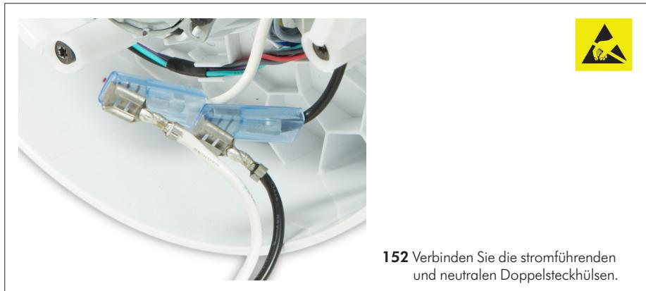
**152** Verbinden Sie die stromführenden und neutralen Doppelsteckhülsen.
