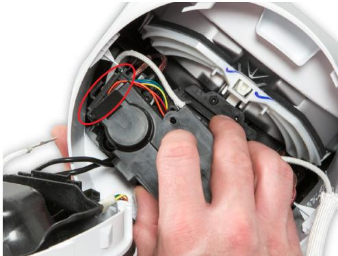
**114** Setzen Sie die Leiste auf der Abdeckung vorsichtig in den Spalt in der Anschlussplatte.
