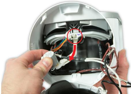
**97** Lösen Sie den Motorhebelarm von der Durchflussfokusklappeneinheit.
