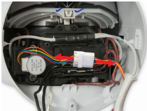
**73** Lösen Sie den Kabelbaum des Modusmotors von den Halterungen. Trennen Sie den Kabelbaum.
