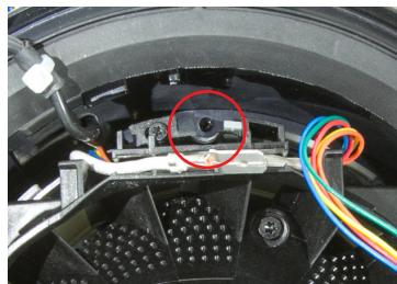
**140** Stellen Sie sicher, dass die Motor- und Halterungseinheit mit den Markierungen auf der Ablage des Hauptgehäuses ausgerichtet ist.
