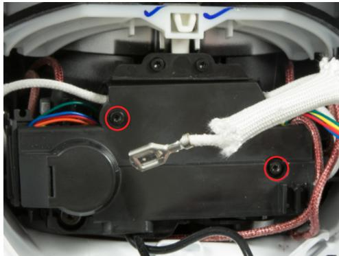
**72** Entfernen Sie die beiden T-8-Schrauben in der Abdeckung. Entfernen Sie die Abdeckung.
