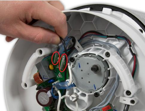
**21** Trennen Sie vorsichtig das stromführende und das neutrale Kabel von der Hauptplatine.
