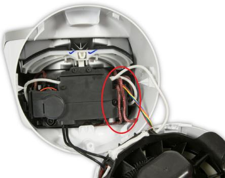
**69** Lösen Sie die Kabel vorsichtig aus der Halterung in der Abdeckung.
