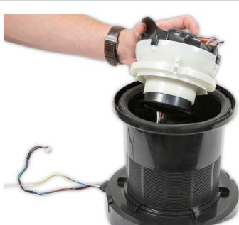
**134** Vergewissern Sie sich, dass alle Kabelbäume frei von der Halterung im Inneren des Hauptgehäuses sind.
