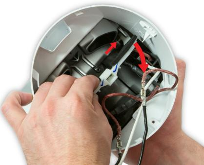
**100** Lösen Sie eine Seite der Durchflussfokusklappeneinheit.
