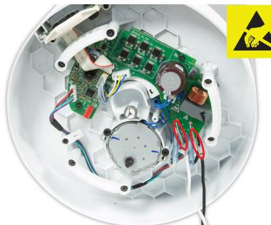
**45** Stecken Sie das stromführende und neutrale Kabel in die entsprechenden Doppelsteckhülsen. Verbinden Sie die Klemmen mit der Hauptplatineneinheit.
