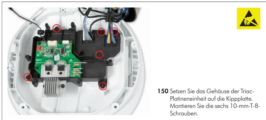
**150** Setzen Sie das Gehäuse der Triac-Platineneinheit auf die Kippplatte. Montieren Sie die sechs 10-mm-T-8-Schrauben.
