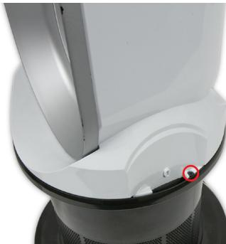
**67** Entfernen Sie die beiden 10-mm-T-8-Schrauben auf beiden Seiten der AMP-Einheit.
