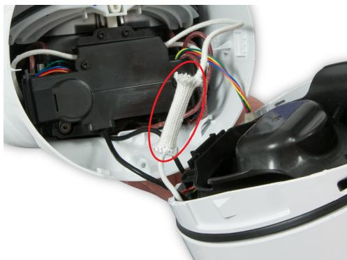
**83 Wichtig:** Positionieren Sie den Glasfasergewebeschlauch vollständig über den Anschlüssen.
