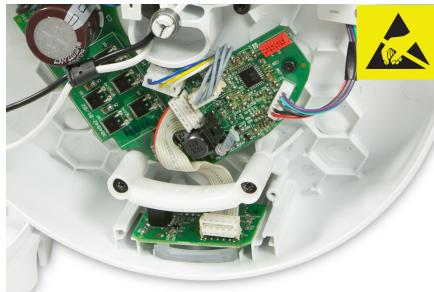
**25** Setzen Sie die Einschalttaste in die LCD- und Platineneinheit ein.
