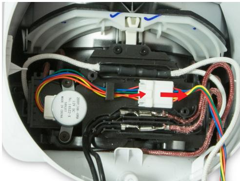
**93** Lösen Sie den Kabelbaum des Modusmotors von den Halterungen. Trennen Sie den Kabelbaum.
