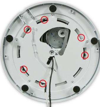
**29** Ziehen Sie die sechs T-15-Schrauben fest (Sie müssen die Basis so ausrichten, dass Sie die Schrauben erreichen können).
