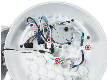
**121** Lösen Sie alle Kabel von den Klemmen im Gehäuse des Unterbodens.
