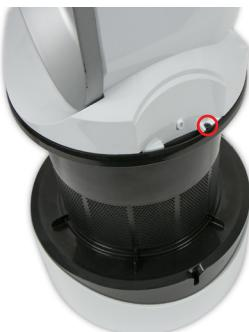
**90** Entfernen Sie die beiden 10-mm-T-8-Schrauben auf beiden Seiten der AMP-Einheit.
