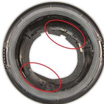
**135** Prüfen Sie die Schaumstoffdichtung der Motorhalterung auf Beschädigungen.
