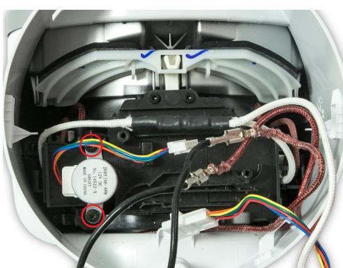
**94** Entfernen Sie die beiden T-10-Schrauben, die den Durchflussmotor halten.
