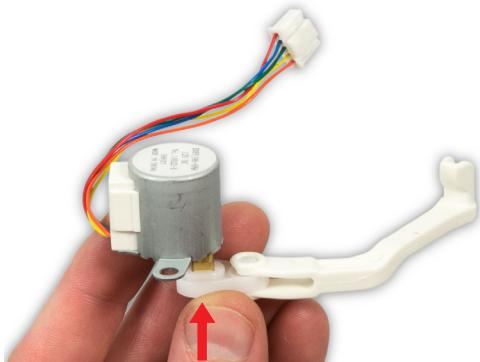
**105** Schieben Sie den Verbindungsarm auf den Durchflussmotor.
