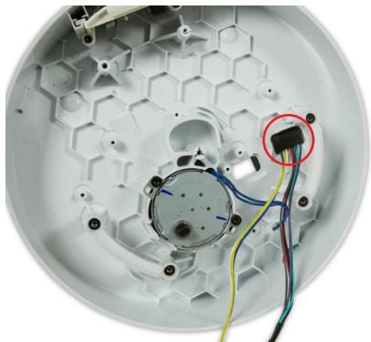
**145** Setzen Sie die kleinere Motorkabelbaumfülle fest in das untere Gehäuse ein.
