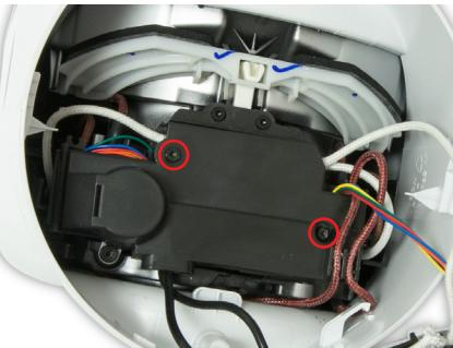
**92** Lösen Sie die Kabel vorsichtig von der Klemmenabdeckung. Entfernen Sie die beiden T-8-Schrauben in der Klemmenabdeckung. Heben Sie die Abdeckung ab.
