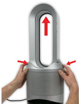
**66** Drücken Sie die Entriegelungsknöpfe auf beiden Seiten der Filtereinheit. Heben Sie die Filtereinheit über die AMP-Einheit.
