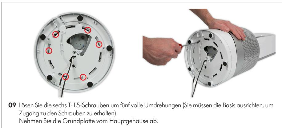
**09** Lösen Sie die sechs T-15-Schrauben um fünf volle Umdrehungen (Sie müssen die Basis ausrichten, um Zugang zu den Schrauben zu erhalten). Nehmen Sie die Grundplatte vom Hauptgehäuse ab.
