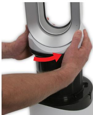
**68** Drehen Sie die Amp-Einheit vorsichtig gegen den Uhrzeigersinn und lösen Sie die Amp vorsichtig vom Hauptgehäuse.
