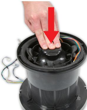
**141** Drücken Sie die Motor- und Halterungseinheit fest in das Hauptgehäuse, um sicherzustellen, dass die Dichtung fest sitzt.
