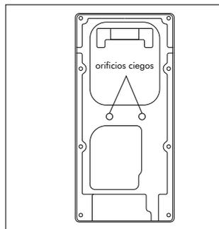
3a - Para montaje **SOLAMENTE** sobre paredes del tipo que tiene divisiones o cavidades.
